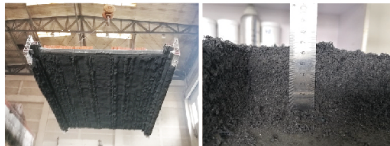
防火实验后膨胀效果 (碳化层完整)
